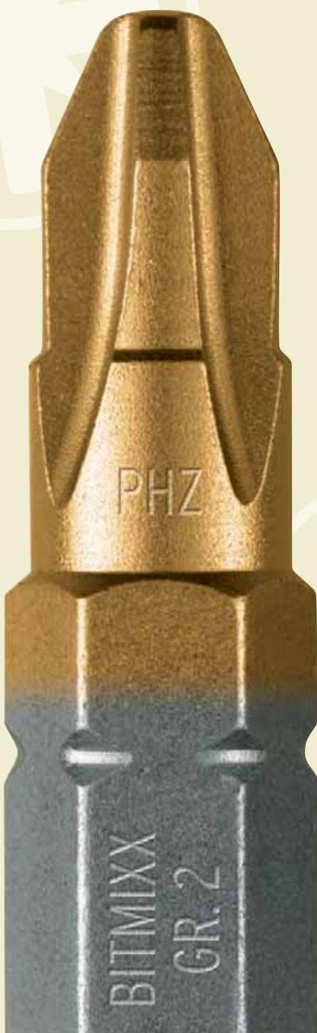
Der PHZ-Bit ist der ideale Problemlöser für Schreiner und Trockenbauer, da diese in ihrem Arbeitsbereich oft Schnellbauschrauben mit PH-Anschlüssen verwenden und die gängigen Spax-Schrauben in den meisten Fällen ein PZ-Profil aufweisen. Ab sofort benötigt man nur noch den PHZ-Bit in den Größen 1, 2 und 3 und deckt damit sechs Größen bei PH und PZ ab.
